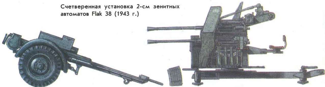
Автомобильный прицеп для перевозки легких зенитных установок
