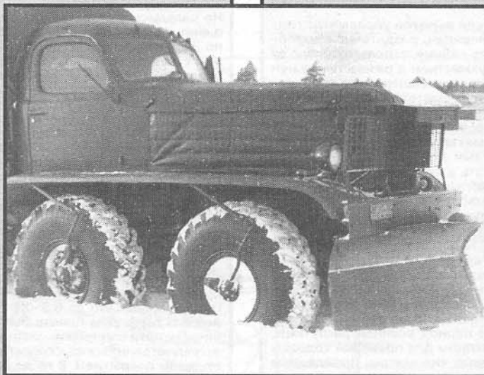
Специальный легкий бульдозерный отвал снижал сопротивление движению по глубокому снегу
