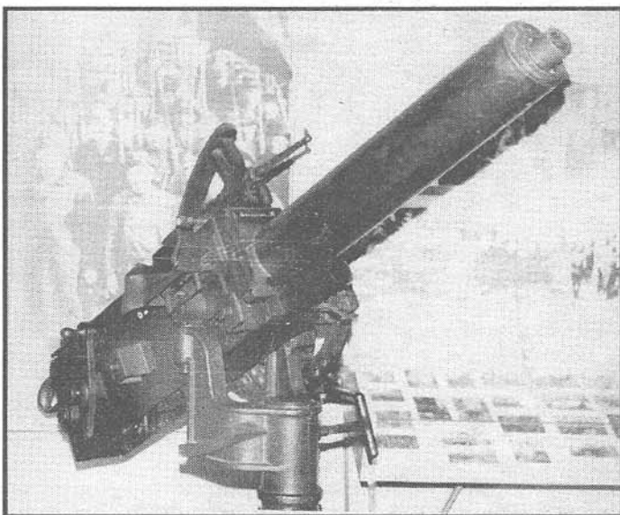
Автоматическая пушка Максима калибра 37 мм
